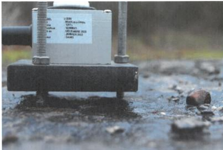
Capteur de vibrations mis en place lors d'une campagne de tirs le 22/01/2021
